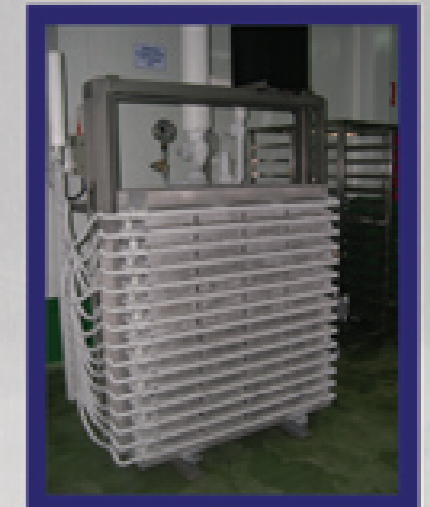
Proyecto de congelador de placas horizontales. Colaboran CIS Galicia y TUNE EUREKA, S.L.
